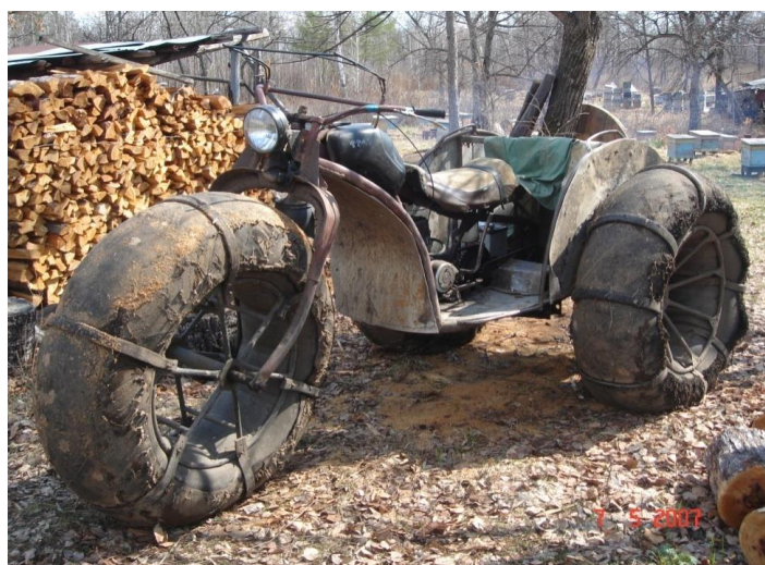
Рис. 1. Трицикл-вездеход с установленными пневматиками низкого давления.
